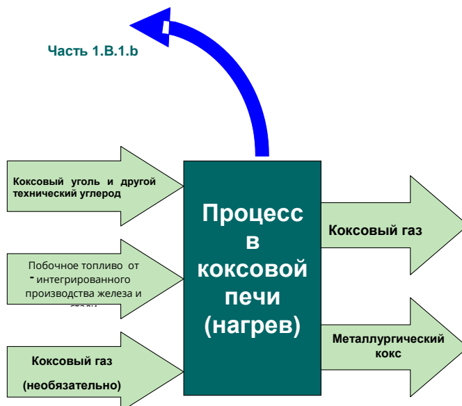
Рисунок 2.1 Технологическая схема производства кокса. Регистрировать выбросы при работе коксовой печи принято в категории источников 1.В.1.в.
