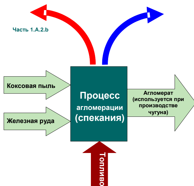
Рисунок 2-3 Технологическая схема производства окатышей. Красная стрелка представляет собой выбросы, образующиеся в процессе горения (см. категорию источников
